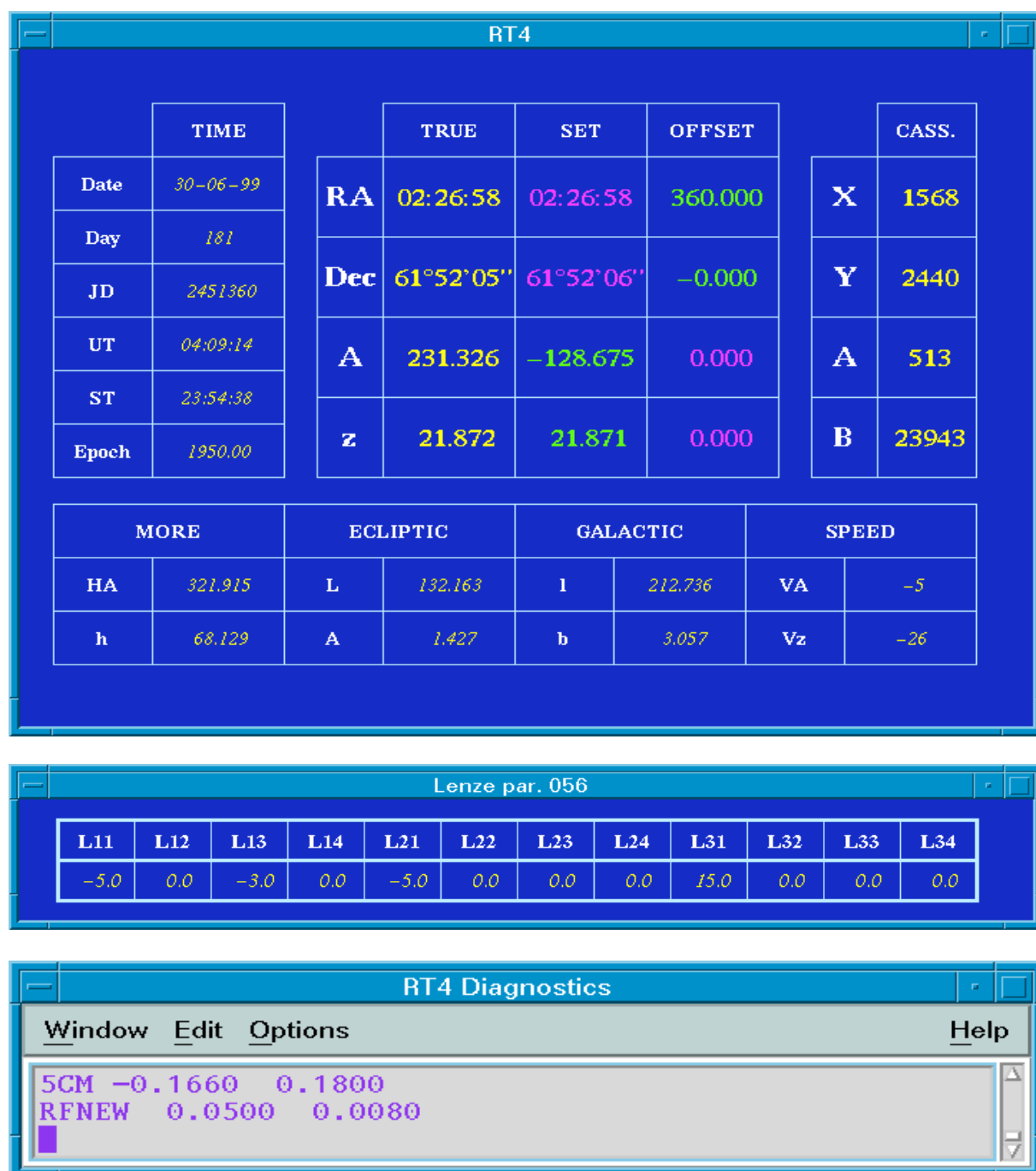
Rys. III.1: Okna monitorujące: RT4 zawierające czas, rzeczywiste i zadane współrzędne radioteleskopu oraz lustra Cassegraina (u góry), parametry napędów Lenze (w środku) oraz diagnostyka niektórych urządzeń (u dołu)
